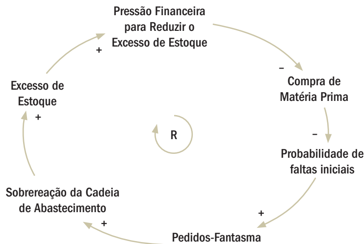
Figura 1 – A pressão direta para a redução do excesso de estoque é auto-reforçadora
